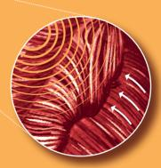
La onda eléctrica viaja a distinta velocidad dependiendo de si va en la misma dirección que las fibras, o si las atraviesa.
